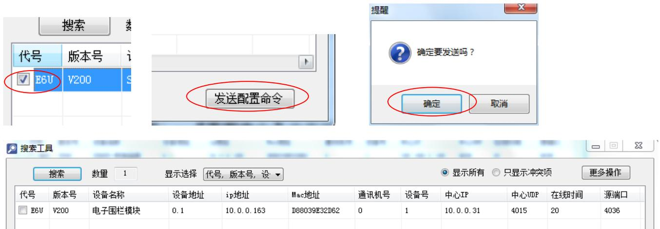
(7) 当【搜索工具】重新搜索到已更改配置的设备后，在设备列表的前面勾选上设备，点击右上角的‘更多操作’，选择导出选择项到中心，退出【搜索工具】，点击【监控中心】左上角菜单栏的‘配置’-‘发布数据’，【监控中心】会自动重启，此时便可查看设备状态，控制设备。如下图：
