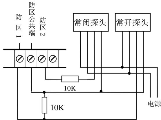
探测设备接线示意图
